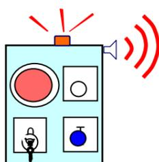
**segnalatore acustico e/o ottico** si attiva ad ogni accesso al bottale prima del tempo minimo impostato (sbarra alzata o fotocellule intercettate, portello automatico aperto etc...)
